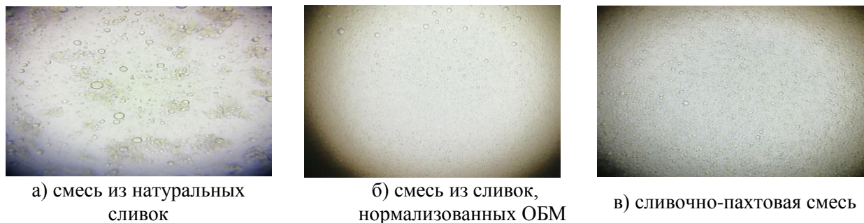
Рис. 3. Микроскопические картины смесей на основе сырья разного компонентного состава
