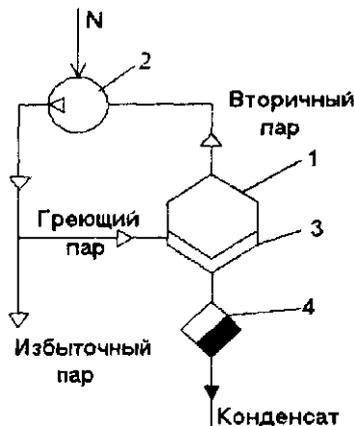
Вторичный пар из сушеварочного котла 1 всасывается механическим компрессором 2 и сжимается до давления греющего пара. Сжатый пар направляется в паровую рубашку 3 котла. Конденсат отводится через конденсатоотводчик 4.
