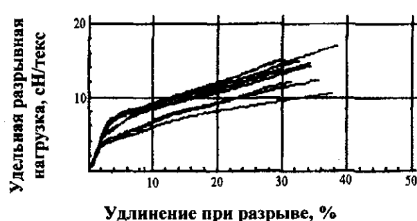
Рисунок 2. Физико – механические свойства PLA волокна, сформованного из раствора в диоксане (параллельные измерения)
