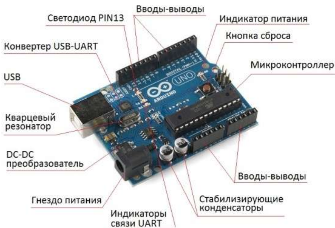
Рисунок 1 – Платформа ArduinoUno на базе микроконтроллера ATmega328
