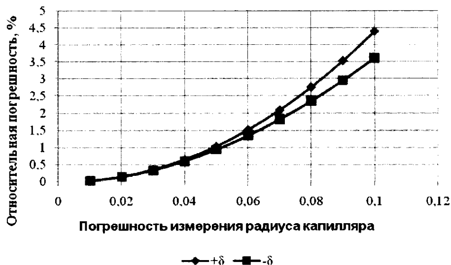
Рисунок 2 – Влияние относительной погрешности определения радиуса капилляра \pm\delta на величину относительной погрешности определения расхода \delta Q_2
