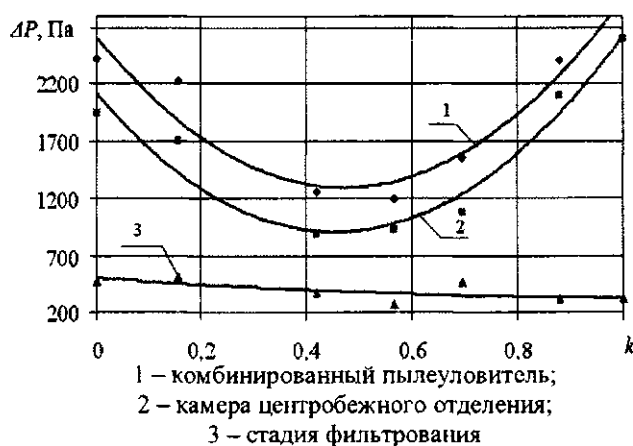
Рисунок 5 – Зависимости потери давления в комбинированном пылеуловителе КПЗС–150–0,14 (а) и эффективности улавливания мелкодисперсных материалов от кратности расходов k при общем объемном расходе газа 300 \text{ м}^3/\text{ч} и высоте зернистого слоя 0,03 м
