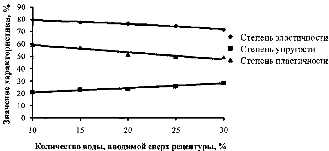
Рисунок 3 – Зависимость степени эластичности, упругости, пластичности от количества воды, вводимой сверх рецептуры
