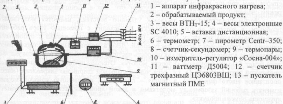
Рисунок 1 – Схема экспериментальной установки
