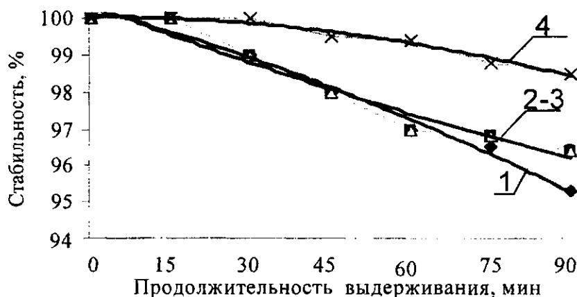
Содержание инулина, % к массе сахара: 1 – 0%; 2 – 1%; 3 – 3%; 4 – 5% Рисунок 5 – Зависимость стабильности пены, полученной при взбивании белково-сахарной смеси, от содержания инулина при температуре 20 0 С
