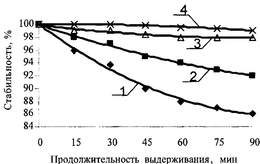
Содержание инулина, % к массе сахара: 1 – 0%; 2 – 1%; 3 – 3%; 4 – 5% Рисунок 5 – Зависимость стабильности пены, полученной при взбивании белково-сахарной смеси, от содержания инулина при температуре 20 0 С
