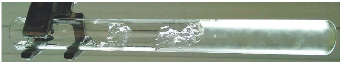
Рисунок 1 – Набухший в воде материал на основе поли[АН(50)-со-АМПС(50)] Экспериментальные величины СОЕ материалов, применявшихся для проведения экспериментов, практически совпали с расчетными значениями (таблица 1).
