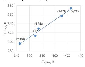
Для получения нагретого теплоносителя в конденсаторах парокомпрессорных тепловых насосов с традиционными рабочими телами холодильных машин требуются слишком высокие давления. Так, например, чтобы получить температуру конденсации 80 °С для аммиака необходимо давление 41.4 бар. Поэтому первым требованиям к рабочим телам тепловых насосов является приемлемое давление при повышенных температурах конденсации. Нами выполнены расчеты теоретического цикла парокомпрессорно-
